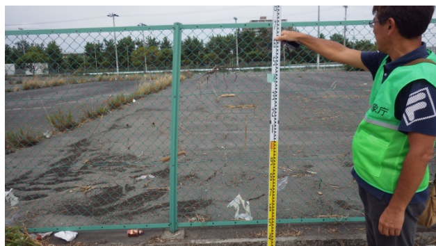
写真6：水準測量実施（西宮市甲子園浜海浜公園付近）
