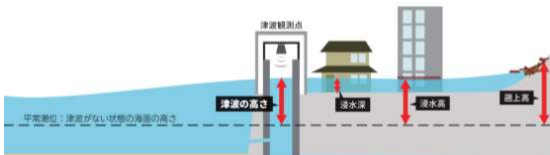
図1 検潮所における津波の高さと浸水深、浸水高、遡上高の関係
