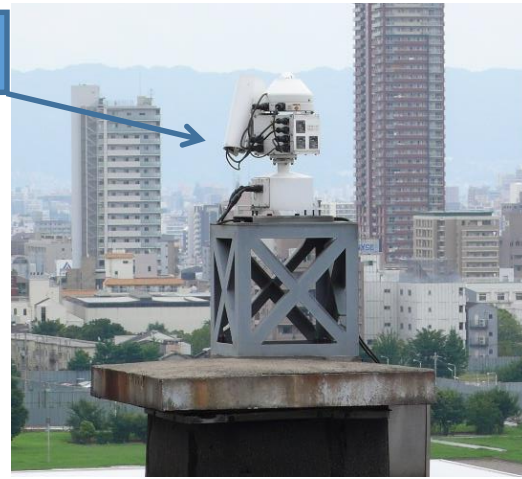
日射日照計は大阪合同庁舎第2号館及び第4号館それぞれの屋上に設置
