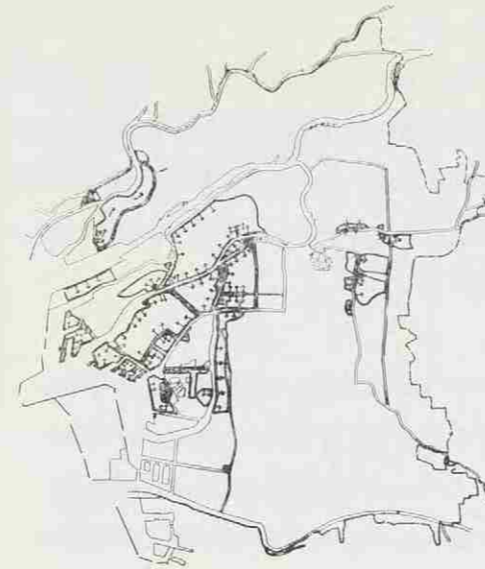
第53図 高潮侵入状況 (・は欠壊箇所 矢印は侵入方向を示す)
