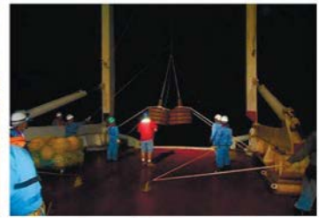
アンカー投入
