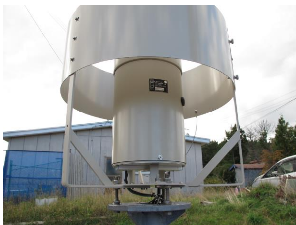
機器更新に伴い導入されたアメダス市浦の「電子制御式ヒータの雨量計」。「温水式雨量計」と比べ、スリムになっていることがわかります。
