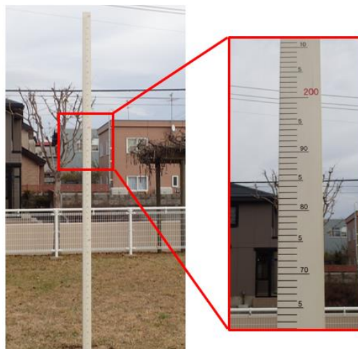
青森地方気象台の露場内に設置している「雪尺」。高さは3mです。
