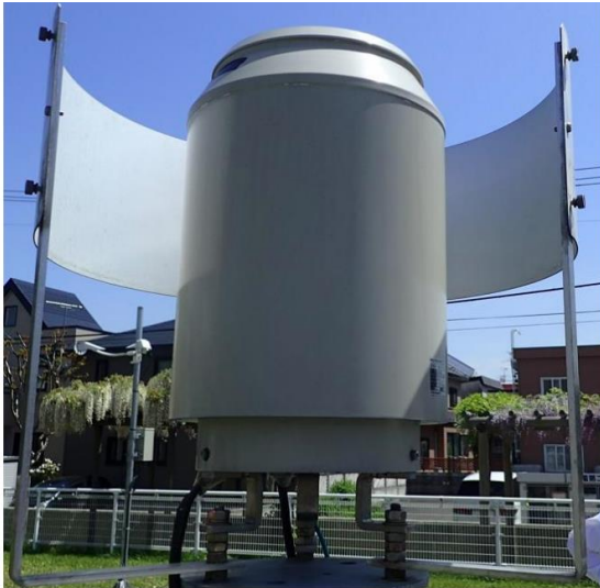
「温水式雨量計」の外観。外筒には不凍液が入っています。風よけの「助炭」の一部を取り外した状態です。
