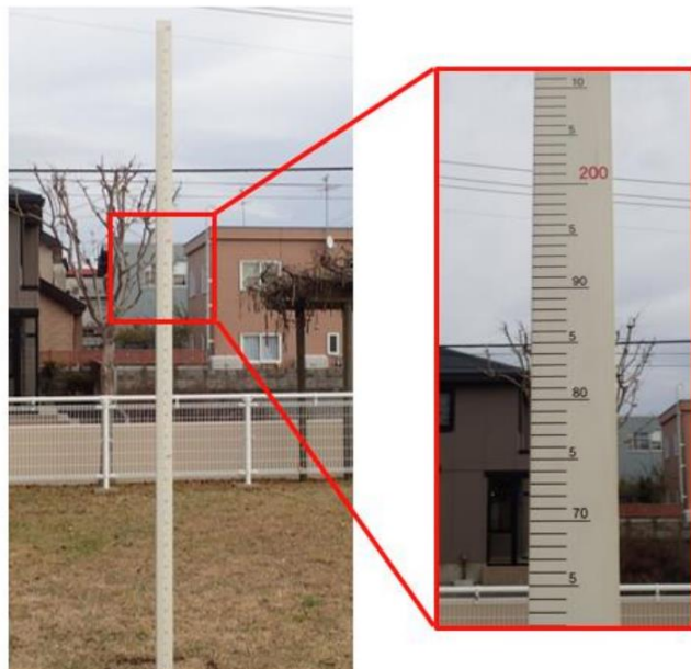
青森地方気象台の露場に設置している「雪尺」。 高さは3mです。
