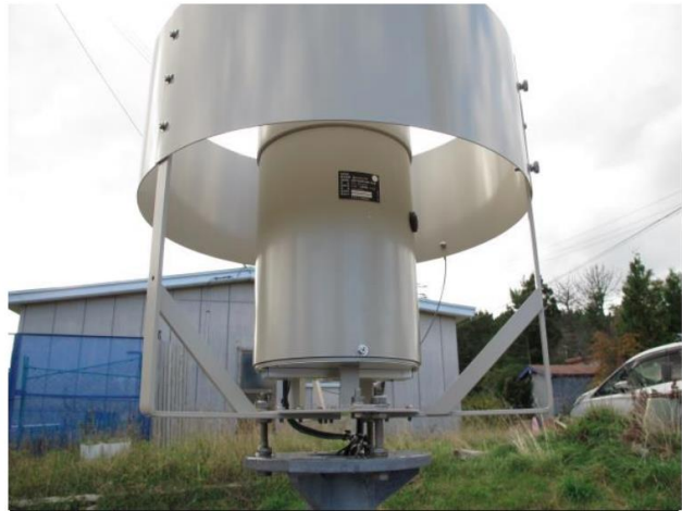
アメダス市浦の「電子制御式ヒータの雨量計」。 「温水式雨量計」と比べ、スリムになっています。
