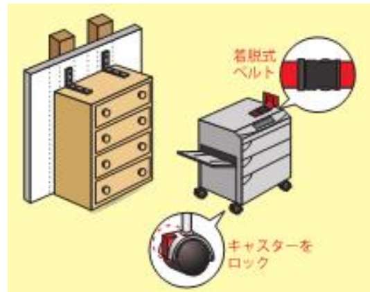
図4 家具類等の固定の例
