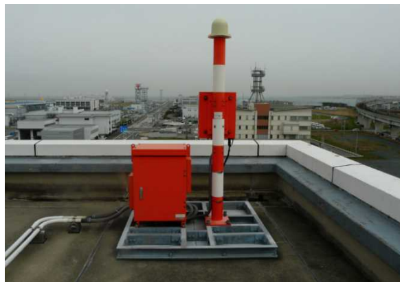
第1図 雷監視システム（LIDEN：Lightning DEtection Network system）の検知局
