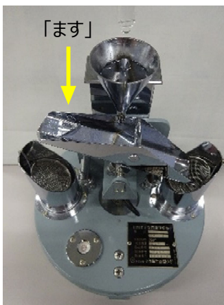
「ます」にたまった雨の重みで、傾くと同時に排水し、今度は反対側の「ます」に雨がたまる
