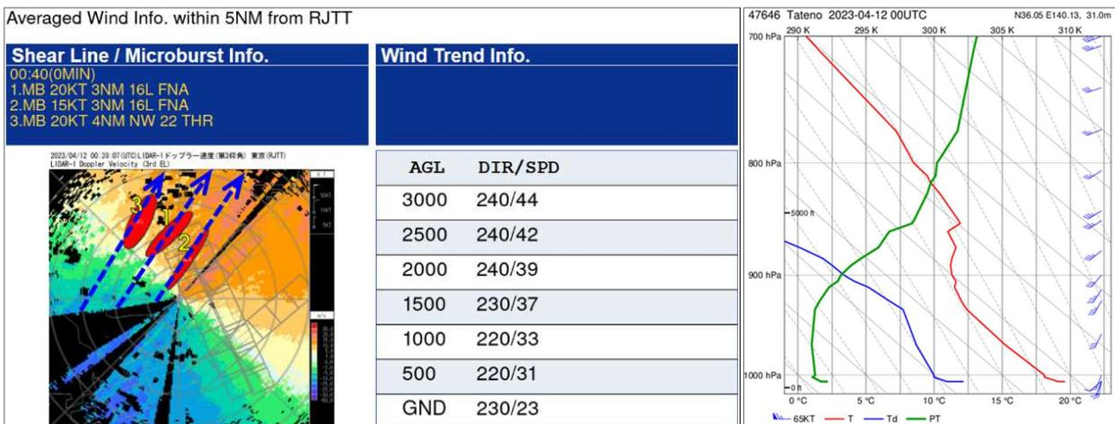
第8図 (左図) LIDAR・1号機のドップラー速度(仰角0.7度)及び空港低層風情報(ALWIN)の各層の風向風速(2023年4月12日0040UTC)
