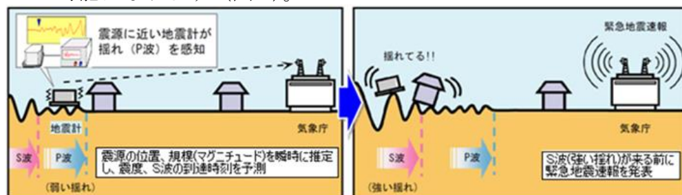
図3 緊急地震速報の仕組み
