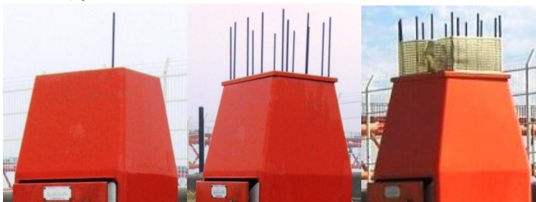
第5図 シーロメーター鳥除けの改良（左：設置当初、中：改良後、右：羽田対応）
