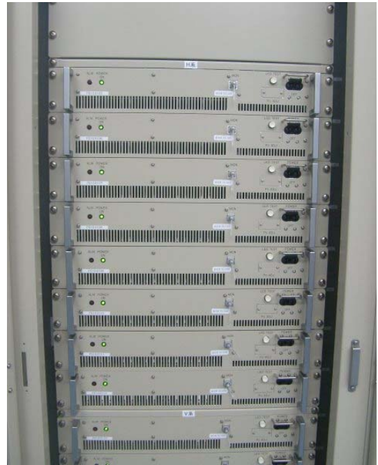
新装置送信機送信モジュール（固体素子）
