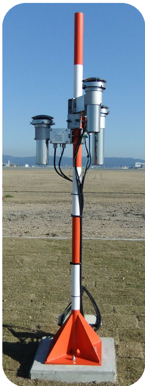
湿度センサと 変換部(センサの変化から 湿度を割り出す装置)
