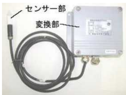
湿度センサと 変換部(センサの変化から 湿度を割り出す装置)
