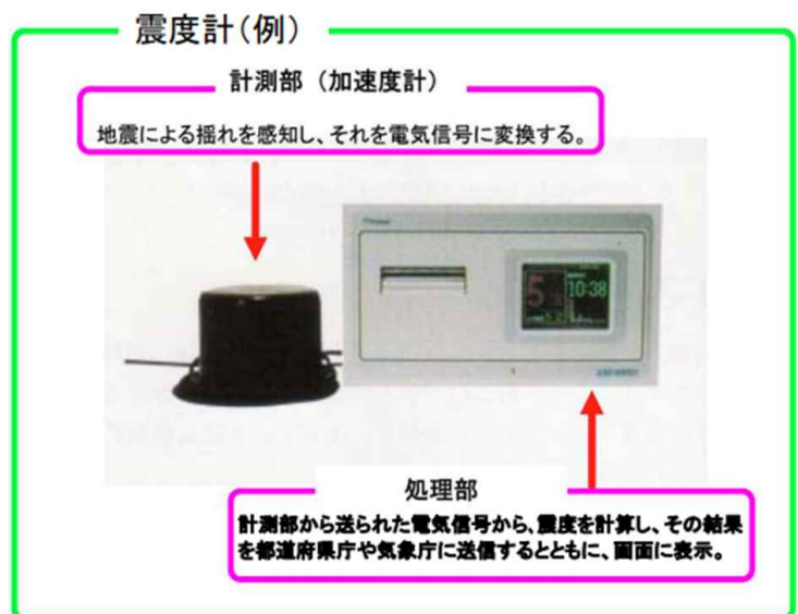
震度計のしくみ
