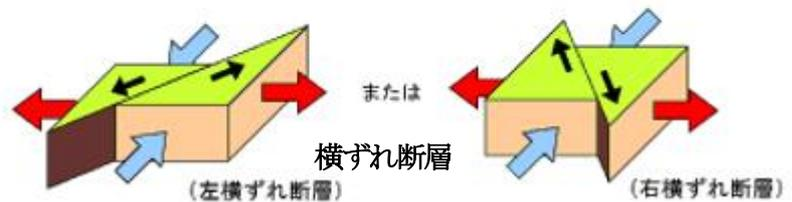
→ ← 圧力 (押す力)    ← → 張力 (引く力)    ⇄ 断層がずれる方向
