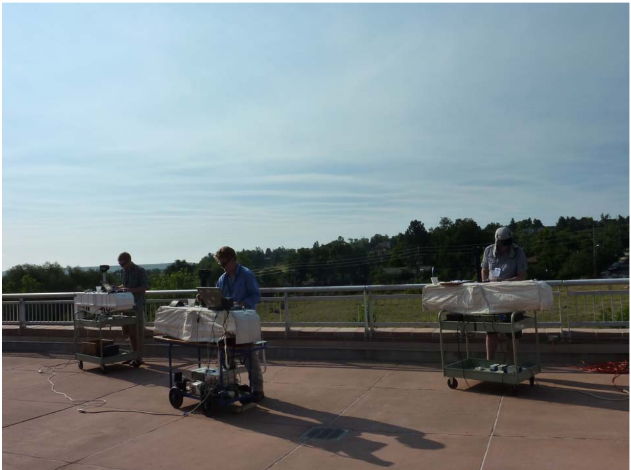
口絵1 NOAA(米国・海洋大気庁)におけるドブソンオゾン分光光度計の比較観測 (庁舎3階テラス, 8月14日, 太陽直射光による比較観測) 左から, 世界第二準器(D065:測器番号を示す), 世界第一準器(D083)及び南西太平洋地区準器(D105)
