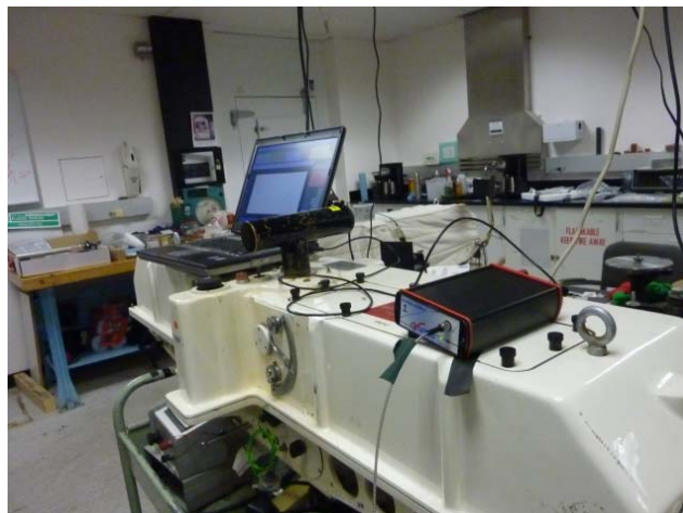
口絵 5 NOAA が現在取り組んでいる測器内部散乱光の測定実験
