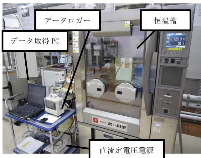
写真 11 オゾンセンサ箱内の湿度測定実験の様子 (恒温槽内) 恒温槽内にオゾンセンサ箱を設置.
