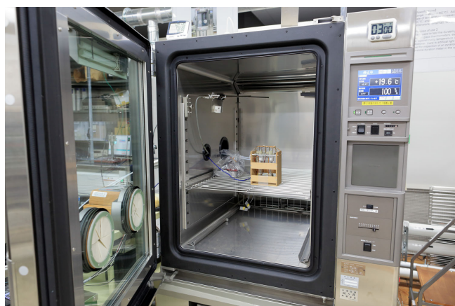
Photo 6 恒温槽の中の反応管設置状況
