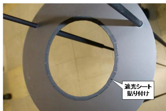
写真7 遮光シートによるエッジの反射低減
