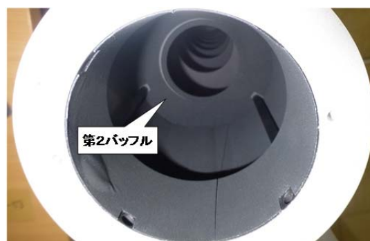
写真5 遮光シートによるコリメーションチューブ内部の反射低減
