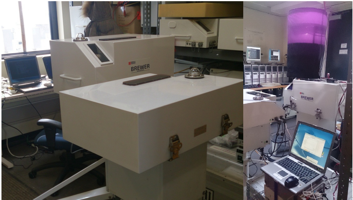
図 3 室内における測器調整及び NIST ランプ検定
