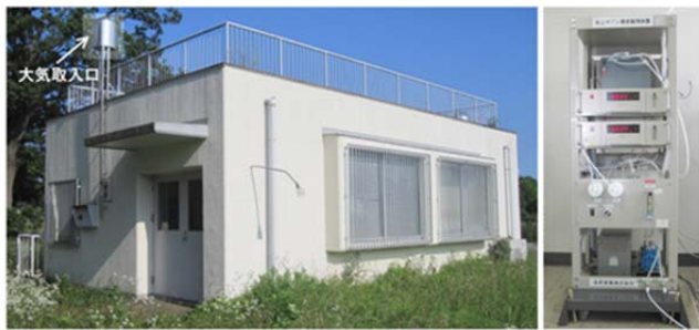
写真1 大気取入口と地上オゾン濃度観測装置
