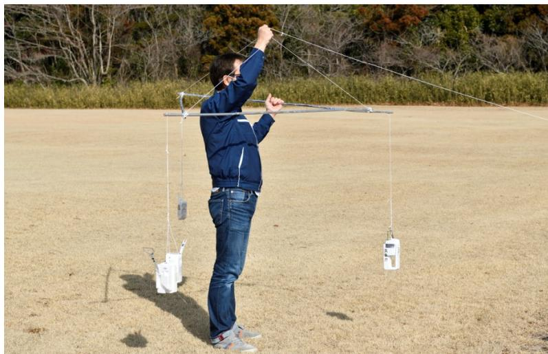
口絵 22 気温基準ゾンデ(MTR)と発信器(RS-11G), RS92-SGP, RS-11G と iMS-100 の連結飛揚(2018年)
