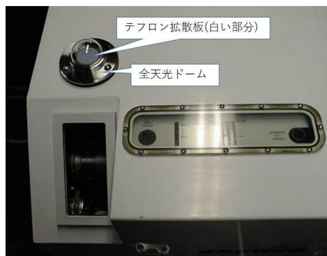
写真 2 外部標準ランプ点検装置のランプハウスを取り付ける受光部の場所
