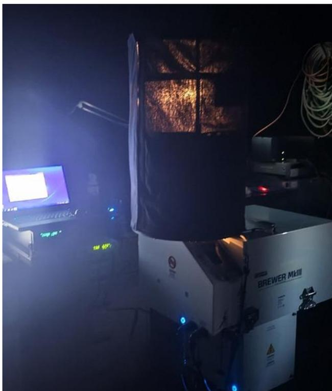
写真3 ECCC 庁舎内暗室での NIST ランプ検定の様子
