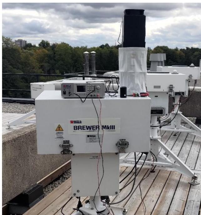
写真2 測器感度を監視する外部標準ランプ点検
