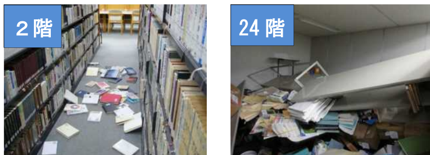
図2 同じビルの高階層と低層階での被害の違い（工学院大学提供）
