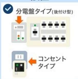
感震ブレーカーの設置
