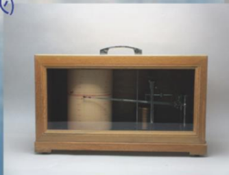
アネロイド気圧計 内部を真空にした管が膨らんだり凹んだりすることを利用して、気圧を測定します。
