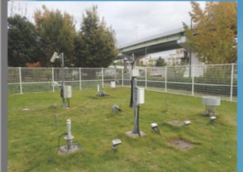
アメダス観測所 雨、風、雪などの気象状況を観測するため、全国に約1,300か所設置されています。
