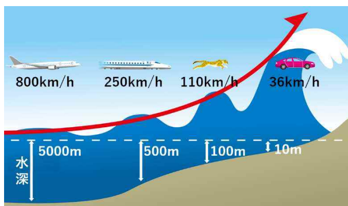
図3 津波の速さと高さの模式図
