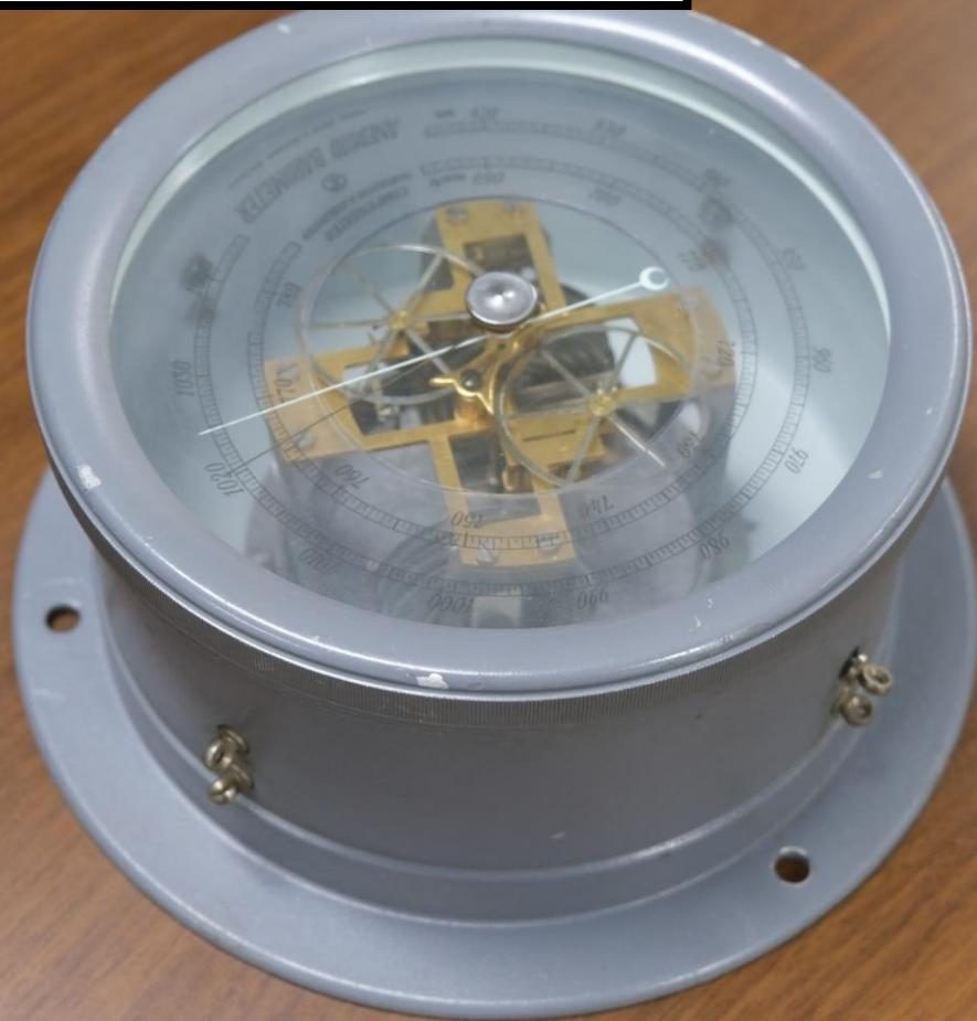
気圧の変化によって、中の真空の金属容器が膨らんだり凹んだりするのを利用して針を動かし、目盛りから気圧を読み取ります。
