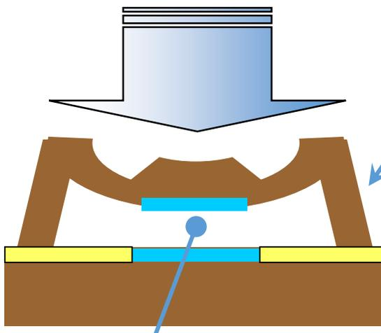
電極間の近さの変化から、気圧を計測
