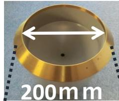
受水部（筒）の中にはヒータが組み込まれていて、雪は溶かして水にしてから降水量を測ります。
