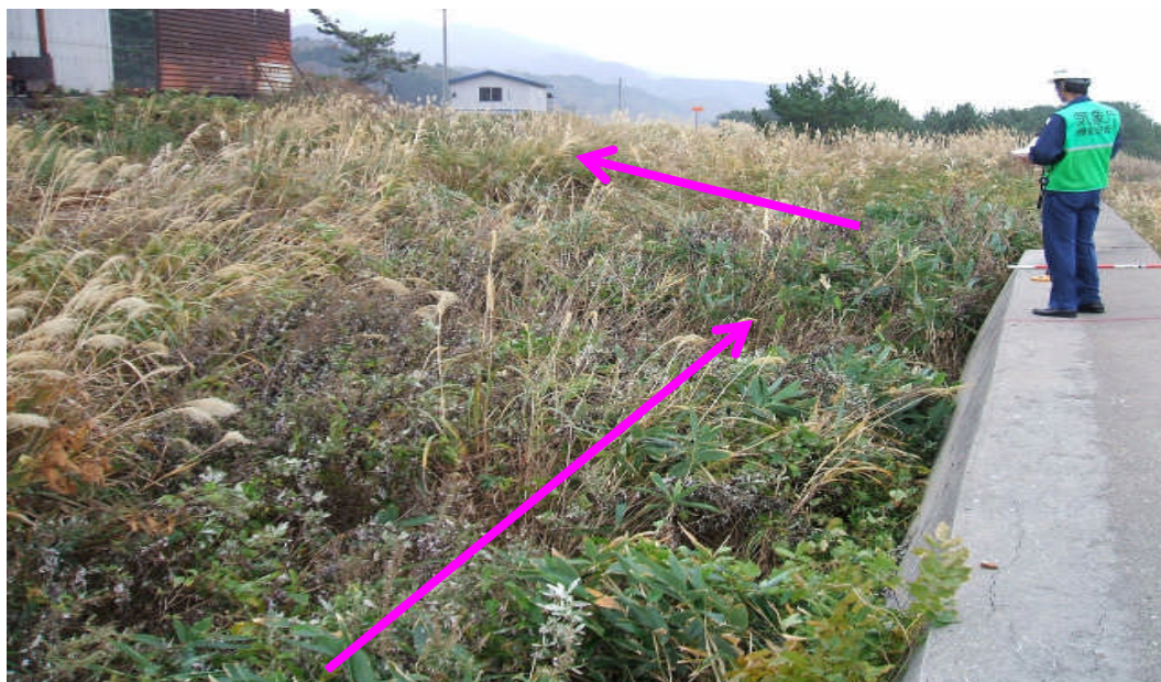
⑨ 枯れ草の倒伏状況から、突風の収束性が確認できる。枯れ草は画像手前から南方向に倒れ、その後東側に倒れている（撮影：北→南）
