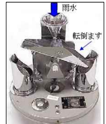
うりょうけい ないぶ 雨量計の内部
